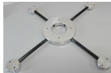
Fig. 3 : exemple de substitut de drone représentant un quadrirotor pour lequel la déformabilité du corps du drone était négligée (Mascarello et al., 2017)
