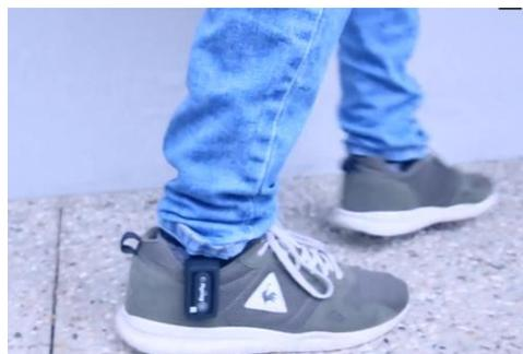
*Centrale inertielle fixée sur la chaussure pour la mesure des caractéristiques de marche*
