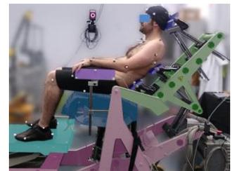
Fig 1. Étude de confort sur siège expérimental où la mousse est remplacée par des vérins miniatures pilotable.
