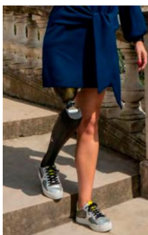
Illustration de la jambe prothétique Synsys de Proteor équipée de capteurs embarqués dans ses composants prothétiques.
