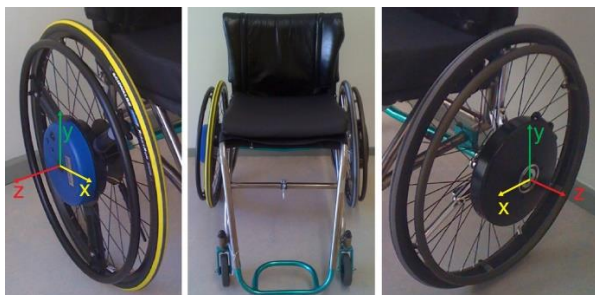
FIGURE 1: Exemple de fauteuil équipé d'une roue à main courante instrumentée issue de (Vegter et al., 2013)
