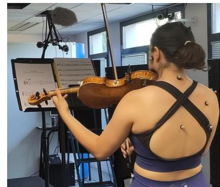
*Figure 1 : Essais sur violoniste avec acquisition du mouvement par un système optoélectronique et enregistrement sonore*
